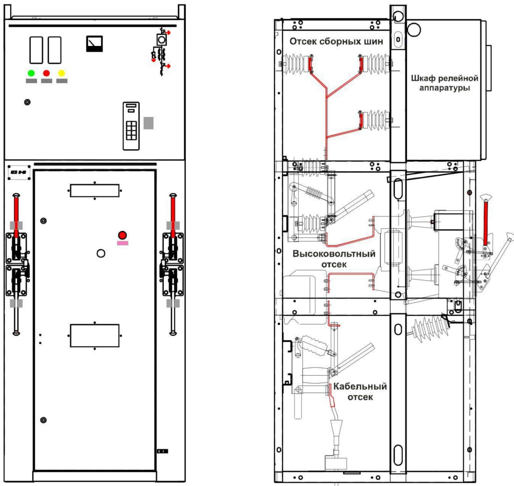
Рисунок 1. Устройство базовой модели камеры КСО2-10
